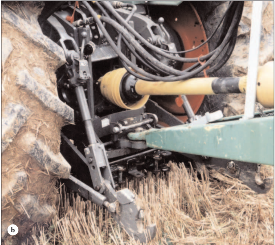
Bild 8b: Standardtraktor mit Piton-Fix-Anhängung – Foto: Autor
