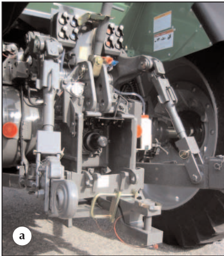
Bild 10: Zugpendelanhangung von landwirtschaftlichen Geräten a) Anhangung bei Anwendungsfall "normal" in Mittelstellung – Werkbild AGCO-Fendt b) Prinzipskizze eines Standardtraktors mit Zugpendelanhangung einer Scheibenegge c) Detailskizze des Zugpendels mit nicht genormter Zugöse für Arbeitsgerät
